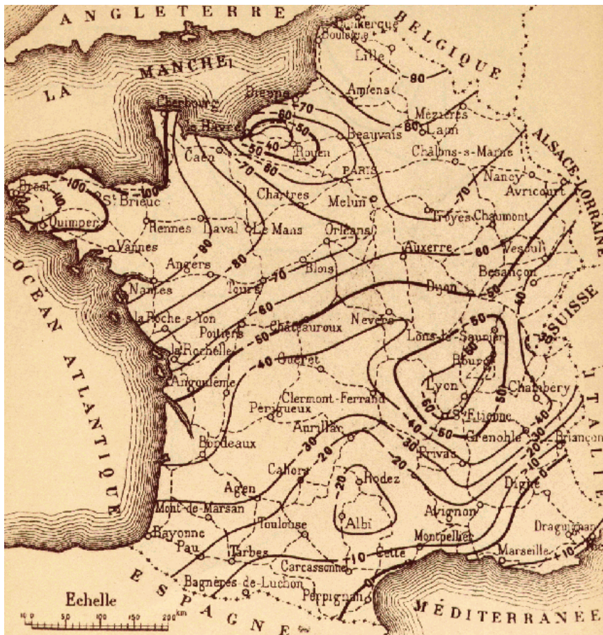
Carte des écarts approximatifs entre les altitudes NGF/Lallemand et les altitudes NGF/Bourdalouë
